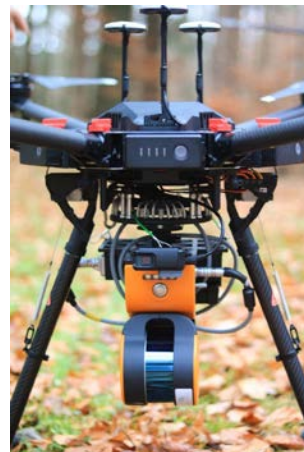
Obr. 4f-6: Dron DJI M600 Pro (DJI – Dà-Jiāng Innovations, 2022) osazený skenerem GeoSLAM Horizon (Geoslam Ltd., 2022) (vlevo), let s dronem DJI M600 Pro (vpravo)
