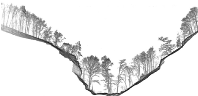
Obr. 4f-7: Řez mračnem bodů získaného náletem pomocí dronu s LiDARem
