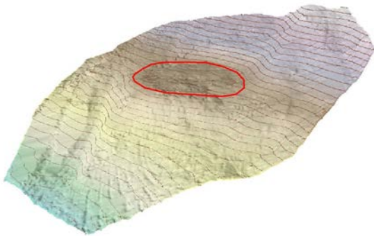
Obr. 4f-5: Vizualizace mířičště zmapovaného pomocí ručního mobilního laserového skeneru
