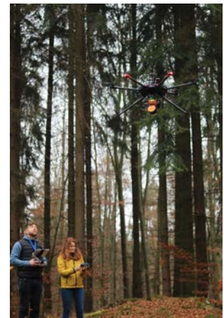
Obr. 4f-6: Dron DJI M600 Pro (DJI – Dà-Jiāng Innovations, 2022) osazený skenerem GeoSLAM Horizon (Geoslam Ltd., 2022) (vlevo), let s dronem DJI M600 Pro (vpravo)
