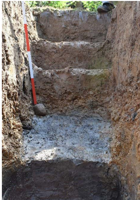
Obr. 4c-2: Výslednou půdní sondu potom podrobujeme půdoznaleckému bádání. Primárně se snažíme získat vertikální řez půdním profilem (a), avšak jednotlivé jasně ohraničené vrstvy lze také preparovat a poté zvlášť popisovat (b).
