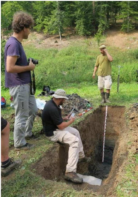
Obr. 4c-2: Výslednou půdní sondu potom podrobujeme půdoznaleckému bádání. Primárně se snažíme získat vertikální řez půdním profilem (a), avšak jednotlivé jasně ohraničené vrstvy lze také preparovat a poté zvlášť popisovat (b).
